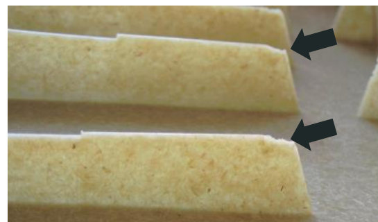
Obrázek 9: Přesná analýza průběhu plnění pro vlákna plněné materiály pomáhá identifikovat plnicí problémy.
