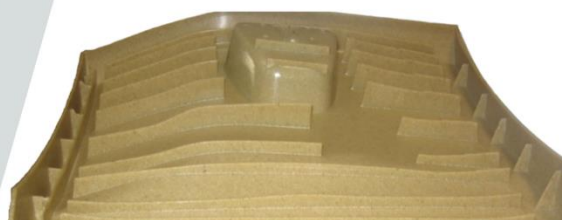
Obrázek 10: CADMOULD Warp, v kombinaci CADMOULD Fiber, zahrne do výpočtu také orientaci vláken. Přesnost výpočtů deformací je zde ukázána na příkladu odkládací schránky (její horní polovině), která je vyráběna z materiálu s přírodními vlákny (NFC). Kombinace modulu Warp s optimalizačním systémem VARIMOS přináší další výhodu optimalizace deformací pomocí automatických metod.
