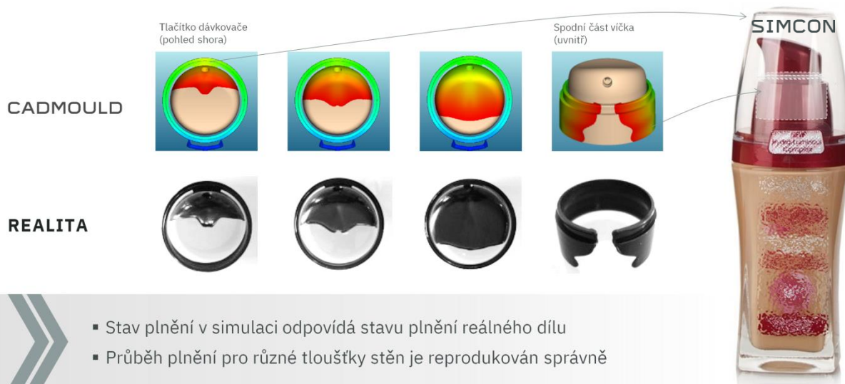
Obrázek 6: CADMOULD byl použit k analýze rozprašovací trysky tohoto flakonu pro L'Oréal Paris. Problematické pro výrobu tohoto dílu jsou její různé tloušťky stěn. Spojení základny víčka a samotným víčkem má velmi tenkou stěnu, která na obou koncích přechází do silnější části. Porovnání výsledků ukazuje, že průběh plnění dílu naprosto dokonale odpovídal průběhu plnění v simulaci.
